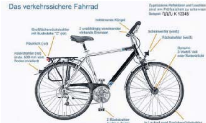
Alles dran: Dieses Schaubild erklärt, wie ein verkehrssicheres Fahrrad ausgestattet sein muss.
